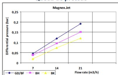
Cartucho de 39”, filtração água a temperatura de 20°C
