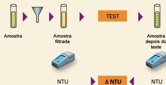
Fig. 1 – Esquema de trabalho para o teste de estabilidade proteica com turbidímetro
